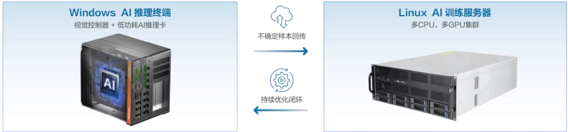
图 4-43 工业视觉 AI 训推系统采用“云边协同”架构，实现持续学习与模型迭代
