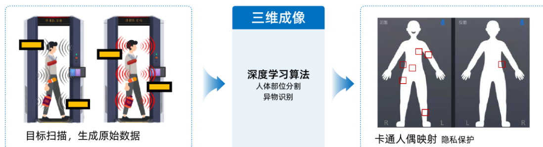
图 4-30 毫米波感知技术有效保护隐私
